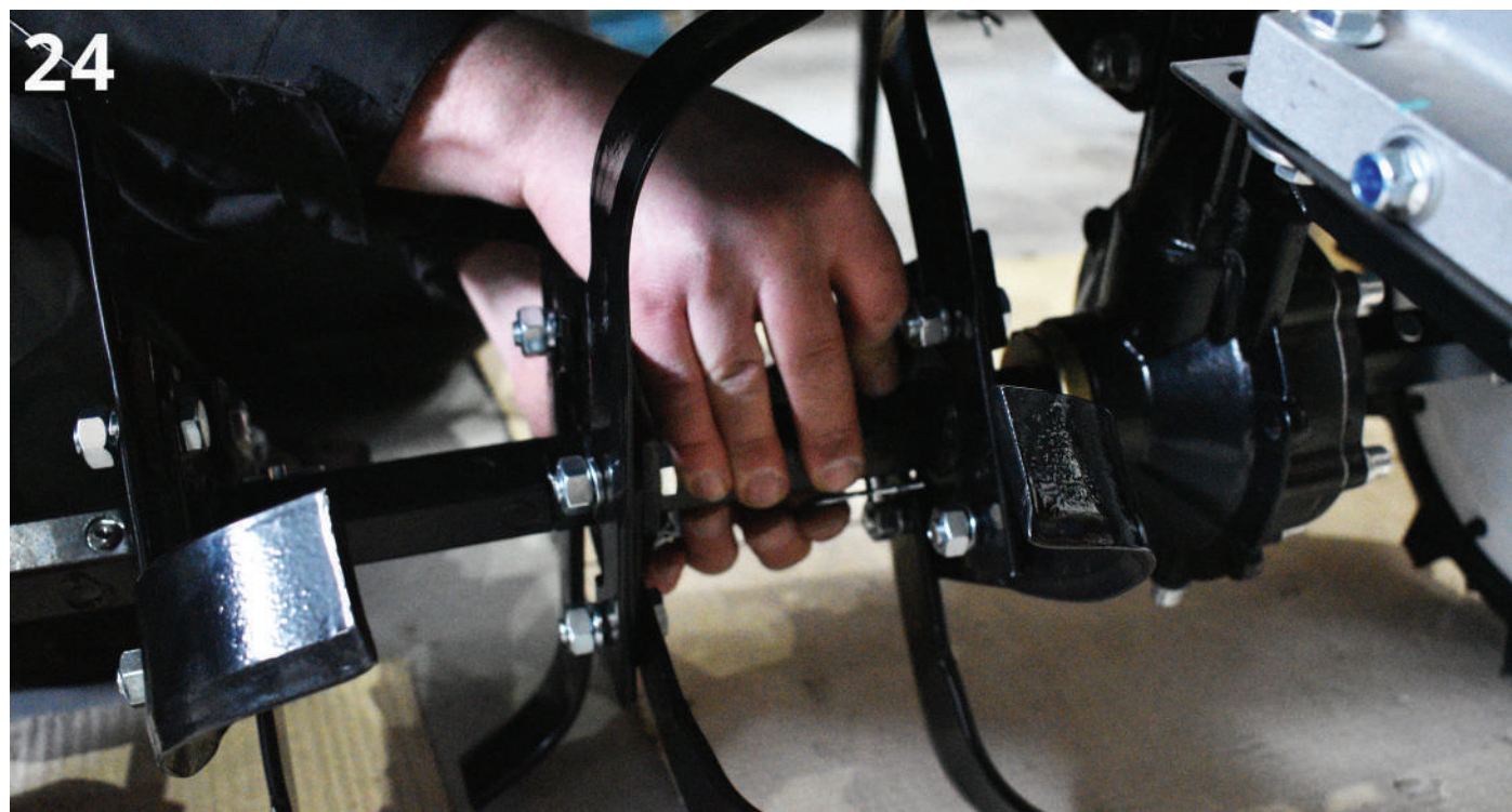
Мал.24. Надягаємо напіввісь з фрезами* на вісь редуктора та фіксуємо за допомогою стопорного пальця.
